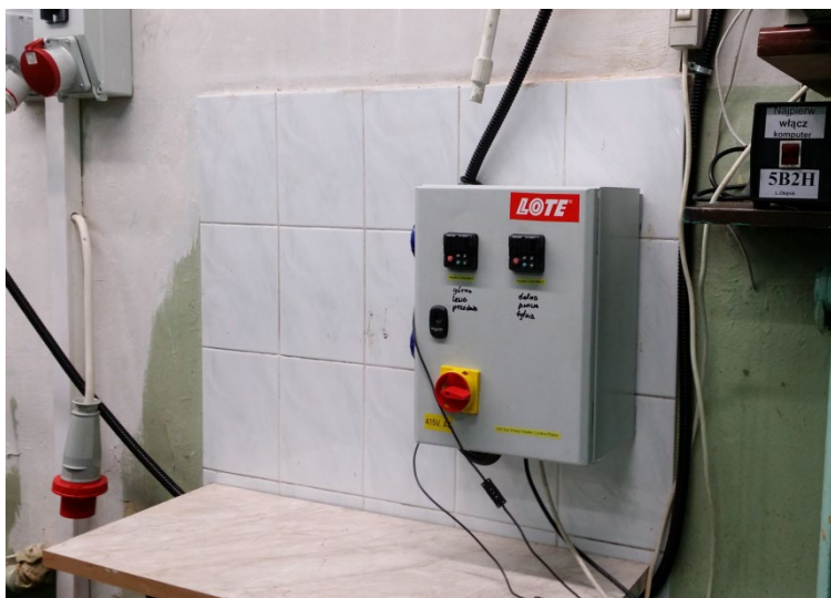
Rys. 2. Dwukanałowy regulator temperatury LOTE do obsługi elektrycznych grzałek w przyrządach dla stanowisk do wydłużania prętów
